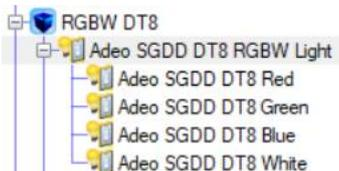
Con l'introduzione della gestione DT8, è stato necessario sviluppare dei driver specifici. Essi infatti espongono una singola connessione in **Connections**, proprio come il protocollo DT8 prevede un unico canale per la gestione del RGBW.
