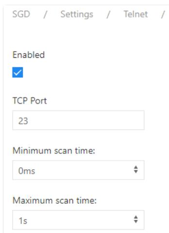
Il gateway dispone di un server Telnet in grado di ricevere e/o trasmettere un universo DMX512A da/per altri dispositivi tramite protocollo TCP, nel nostro caso verso il driver Control4.
